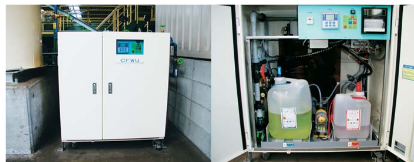
生成機 次亜塩素酸ソーダと水を反応させ発生する水酸化ナトリウムを、塩酸で希釈反応させ安定した次亜塩素酸水を生成。
